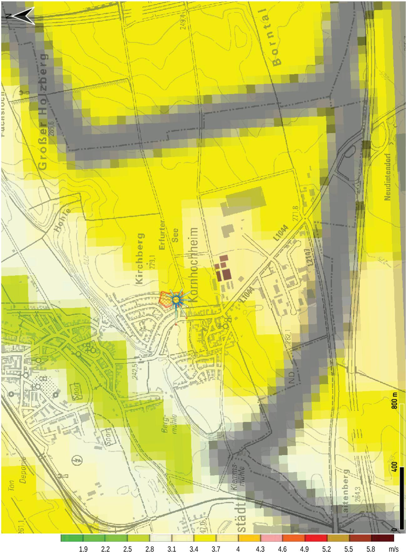
Abb. 7: Windgeschwindigkeitsverteilung nach dem Statistischen Windfeldmodell (SWM) des DWD | Kartenhintergrund: DTK, TLVermGeo
